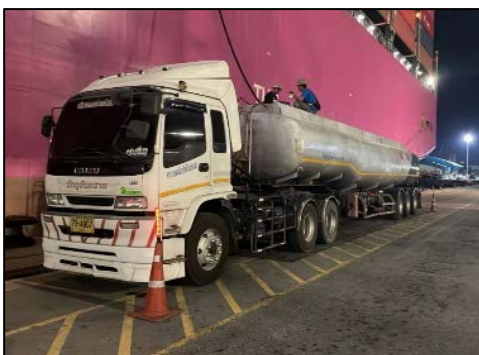
รูปที่ 2.3 การขนถ่ายน้ำเสียปนเปื้อนน้ำมัน
